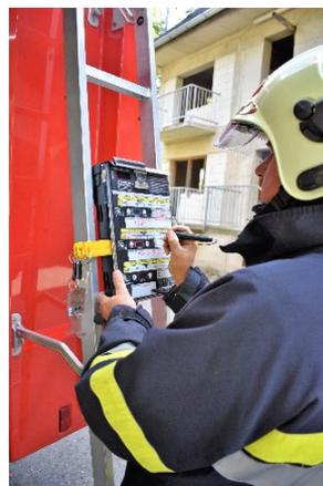
Abbildung 18: GK überträgt die Daten auf das AÜWG und justiert auf den tatsächlich gemeldeten Flaschendruck
