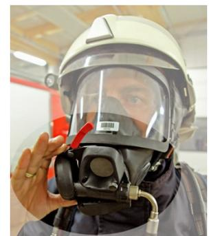
Abbildung 24: Öffnen des Hatch-Systems
