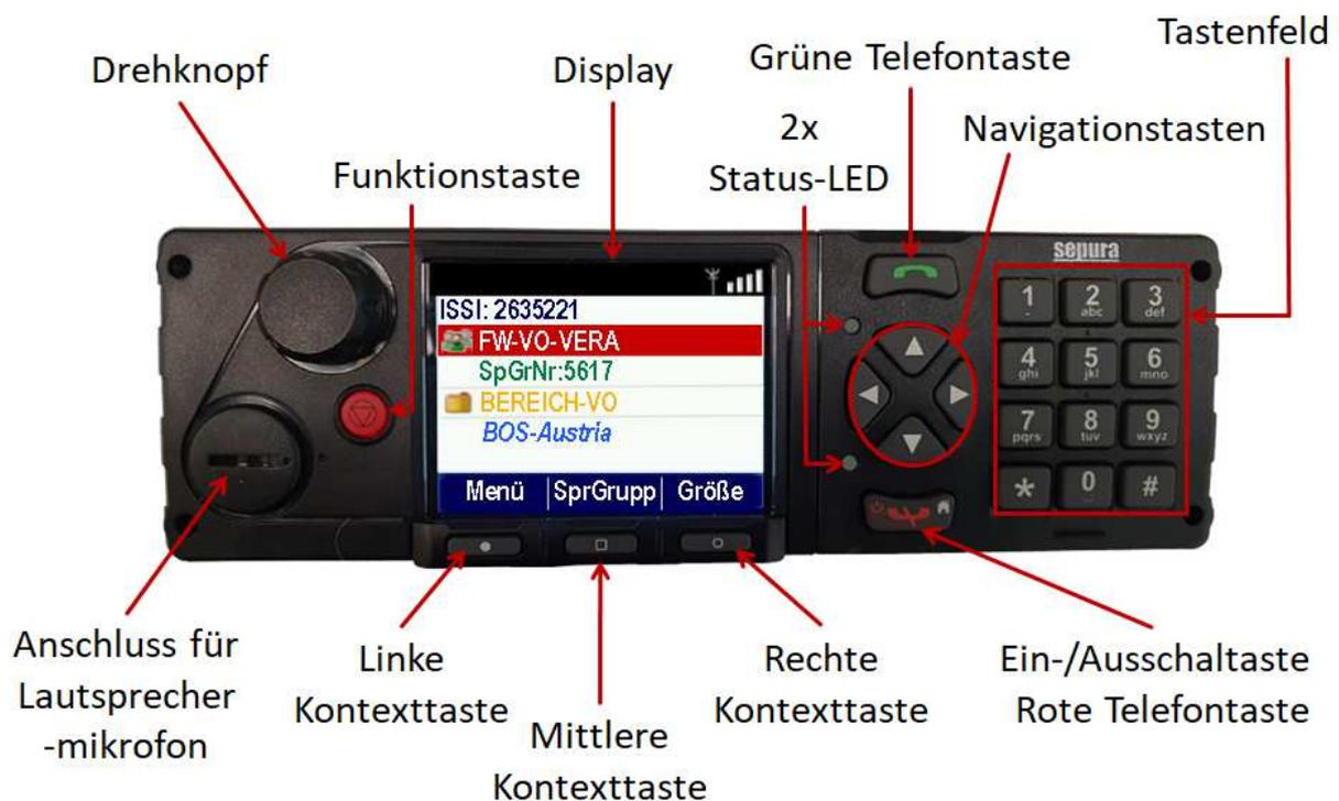
Die Bedienung des SCG22 mit SCC3 ist fast zur Gänze identisch mit dem SC20. Die Display-Gestaltung und die Menü- und Ordnerstruktur sind völlig identisch. Ebenso sind drei Kontexttexten sowie die Funktionen des Drehknopfs und des Ein-/Ausschaltknopfs gleich.
