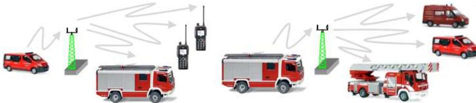
Beim Einschalten des Funkgeräts bzw. beim Wechsel in den Betriebsmodus „TMO“ erfolgt die auf der vorherigen Seite angesprochene Authentifizierung. Ein Funkgerät bucht sich im Netz also nur dann ein, wenn das jeweilige Gerät im System als „berechtigt“ gespeichert ist.
